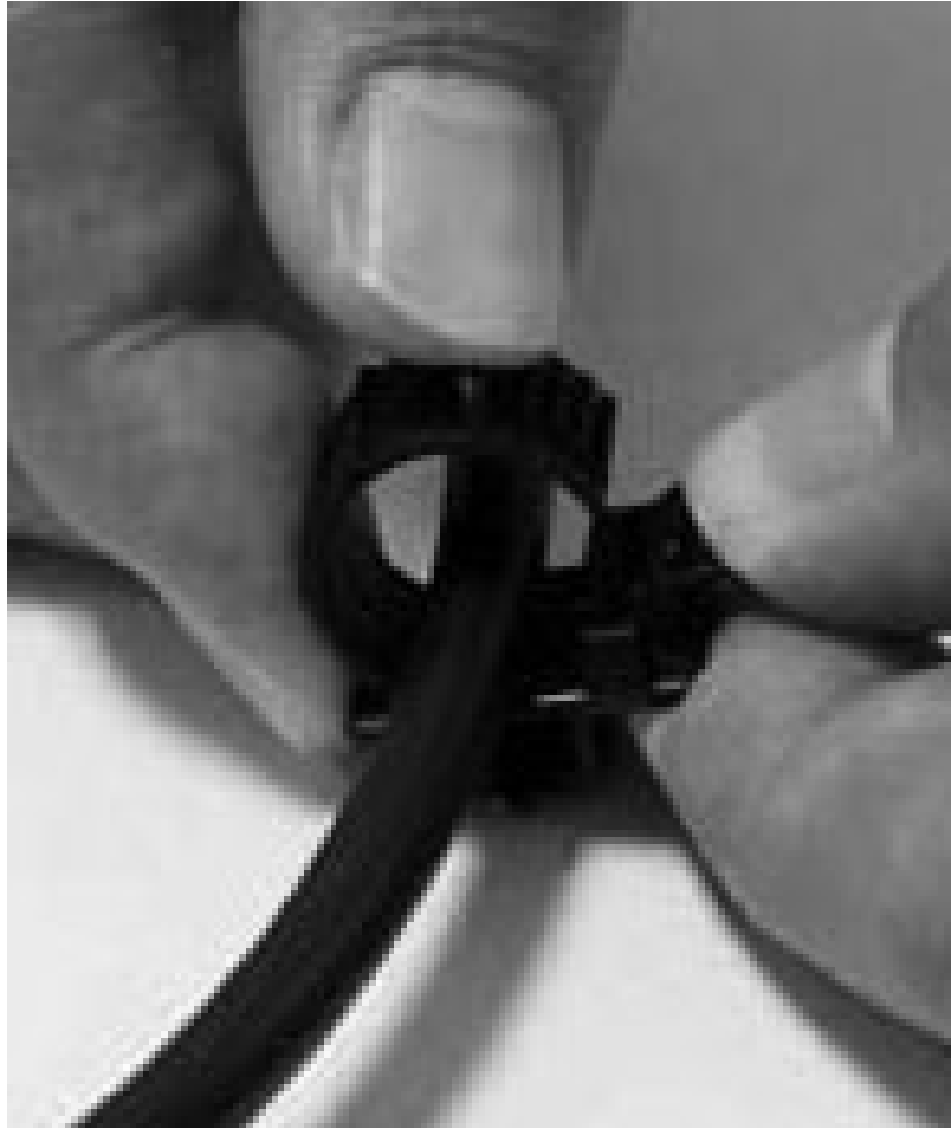
図 55. ケーブル保持ブラケットのロック解除
