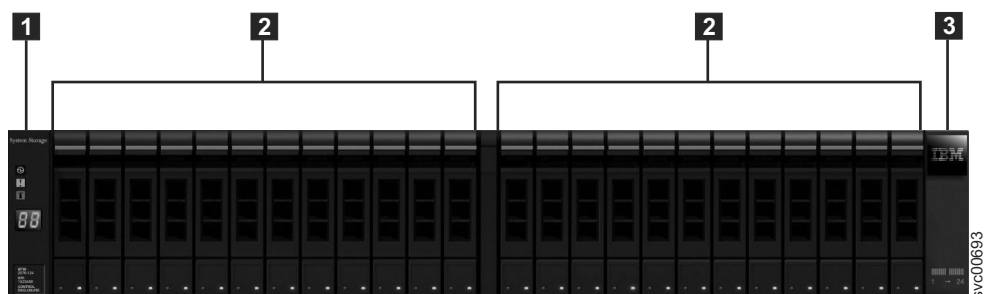
図 2. この図は、24 個のドライブおよび 2 個のエンド・キャップ (モデル 2076-124) を示しています。
