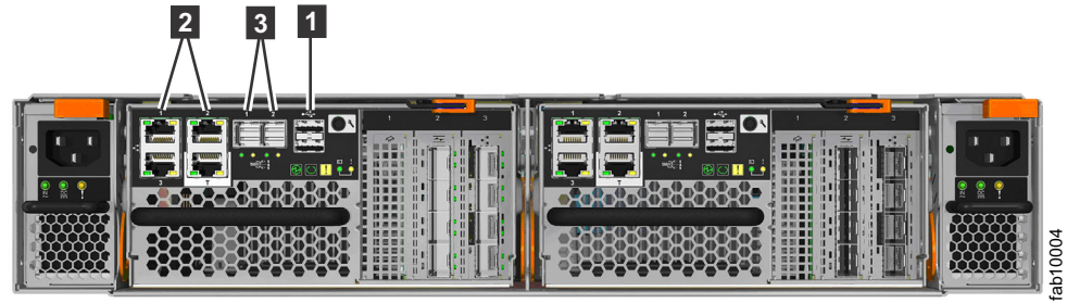
図 7. Storwize V7000 Gen2 コントロール・エンクロージャの背面のデータ・ポート (2076-524)
