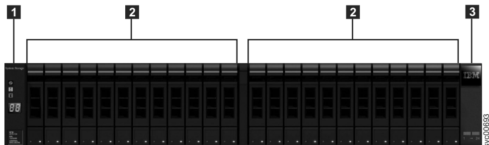
図 58. 24 個のドライブと 2 個のエンド・キャップ
